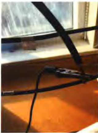
Step a: alligator clip on (+) wire
