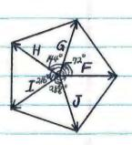
$F_{X} + G_{X} + H_{X} + I_{X} + J_{X} = 0$   $F_{Y} + G_{Y} + H_{Y} + I_{Y} + J_{Y} = 0$   $F_{X} + G_{X} + H_{X} + I_{X} + J_{X} = 0$   $F_{X} + G_{X} + H_{X} + I_{X} + J_{X} = 0$
